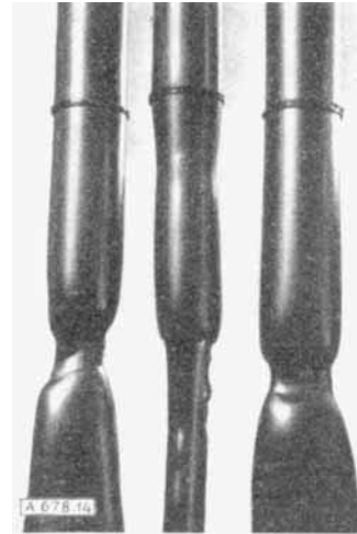
Bild 14 Stumpfschweißverbindungen nach dem Zugversuch
